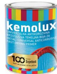
Nanošenje prskanjem zahtijeva temperaturu premaza od 15 °C ili višu te razrjeđivanje premaza s max 5 % razrjeđivača. Preporučuje se izlazni pritisak od 15 MPa, otvor mlaznice od 0,011" do 0,017" (od 0,27 do 0,43 mm), kut mlaza od 30° do 80° te redovito provjeravanje čistoće filtra. Podaci za prskanje dani su kao smjernica te se po potrebi mogu dodatno podešavati.
